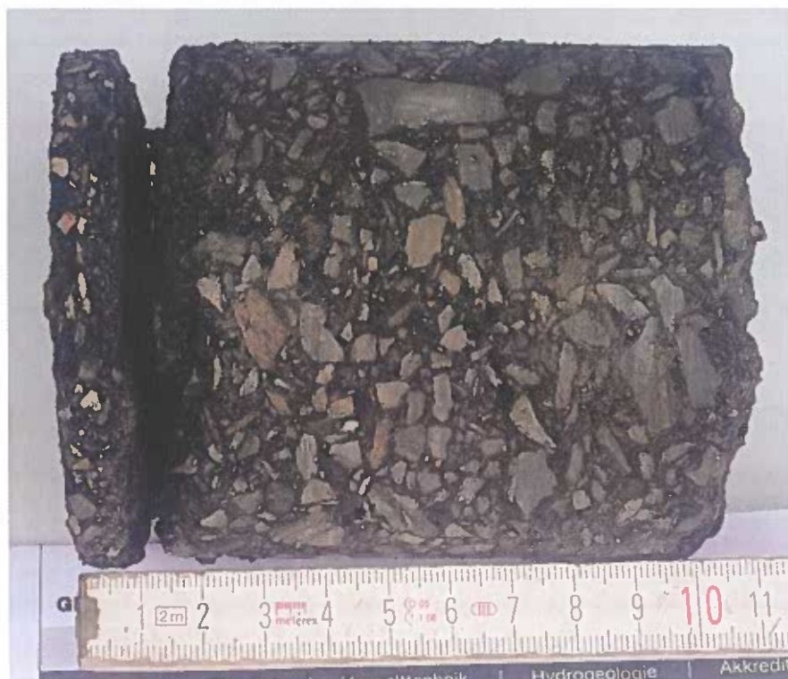
Bild 6: Bohrkern Schwarzdecke RKS26 Baugebiet
