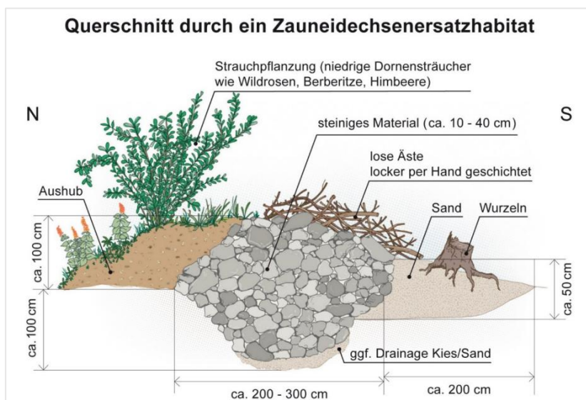
Prinzipskizze eines Ersatzhabitats mit Überwinterungsmöglichkeit, Totholz und Eiablagesubstrat. Arbeitshilfe zur speziellen artenschutzrechtlichen Prüfung: Zauneidechse, LfU (2020)
